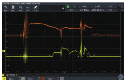
图6 S1、S3触头切换时序电压波形图
