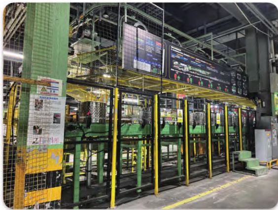
图5 某企业通过产品工艺法布局降低了在制品库存
