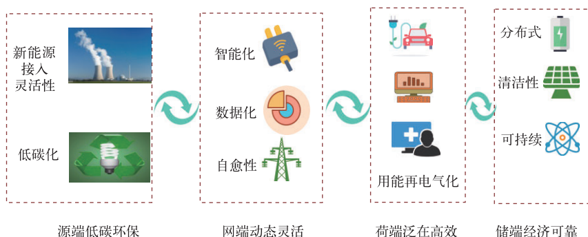
图1 新型电力系统“源网荷储”典型特征
