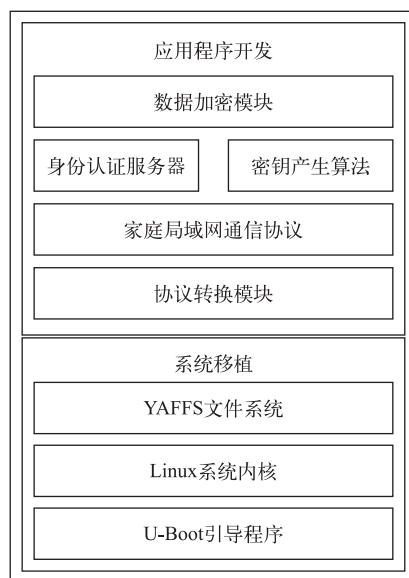
图9 嵌入式网关软件架构
