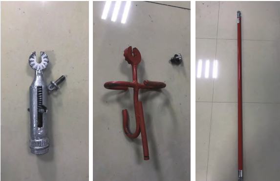
图2 地电位安装避雷器操作工具各部件
