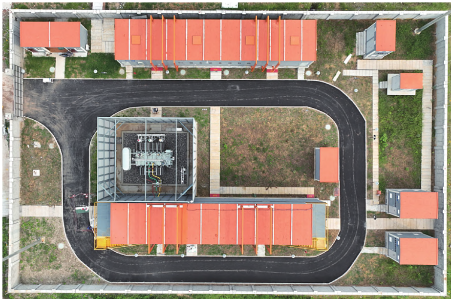
图1 110\ \text{kV} 全模块化高性能纤维预制舱式变电站鸟瞰图
