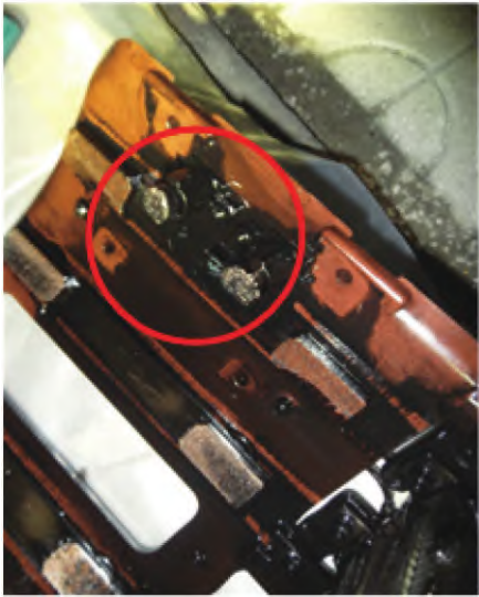
图4 主触头烧蚀图
