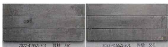
(a) 母材试样 (b) 焊缝试样 图4 母材及焊缝试样720 h SSC试验后表面宏观照片
