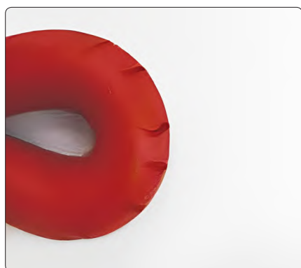
图 2 管路 O 型圈常见损坏情形
