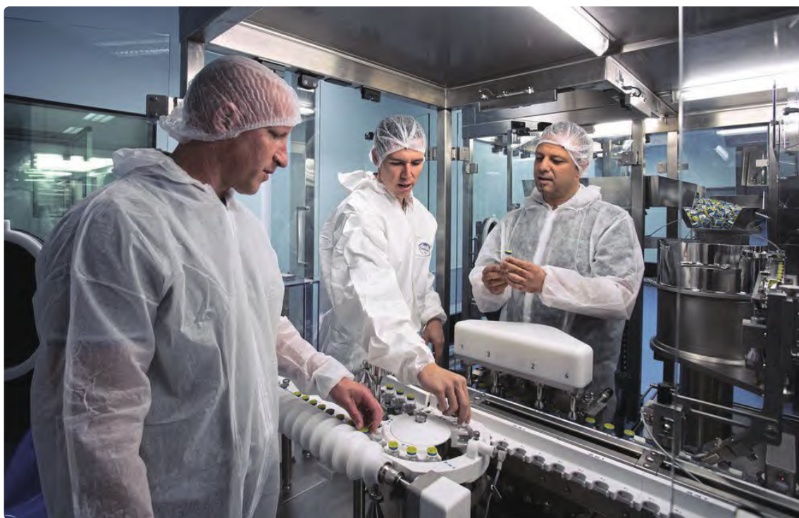
Ted 系列清洗机、灭菌通道和灌装平台可以支持 Aspen 灌装较大的小瓶和卡式瓶
