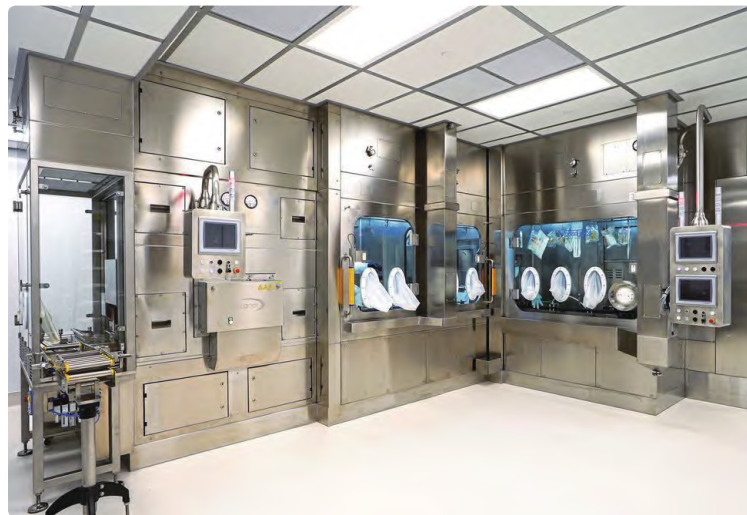
用于处理 RTU 型玻璃容器的生产线
