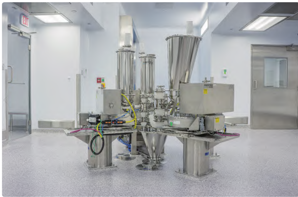
上层的科倍隆楷创失重式喂料机位于专门的旋转轨道上，以获得更好的可接触性
