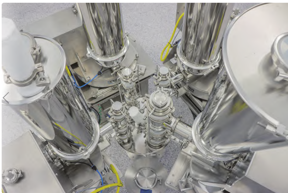
多台科倍隆楷创喂料机同时按照组份配比进行精确喂料
