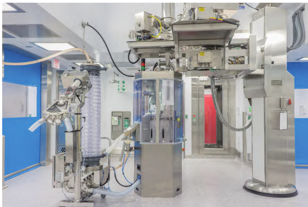
连续直接压片系统，包括定制升降组件上的科倍隆楷创失重式喂料机
