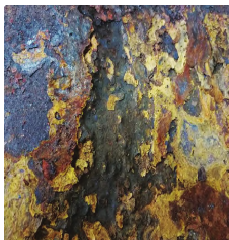
图6 内表面腐蚀形态
