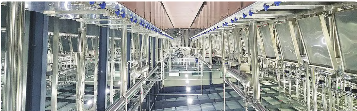
图2 中药连续逆流动态提取机组
