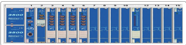
图 7 六机柜间监测系统框架具体配置
