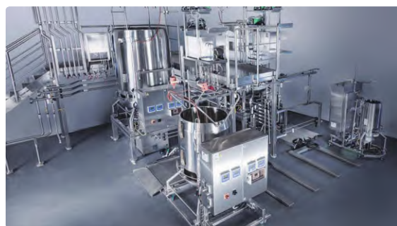
用于集成 4 个一次性生物反应器的不锈钢平台（反应器的容量分别为 50 l、500 l、2 × 2000 l）
