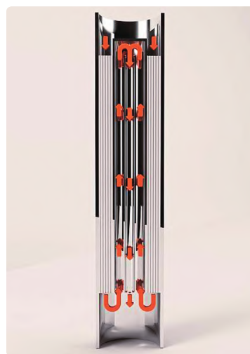
增强型环形转化管制氢 (EARTH® 技术)
