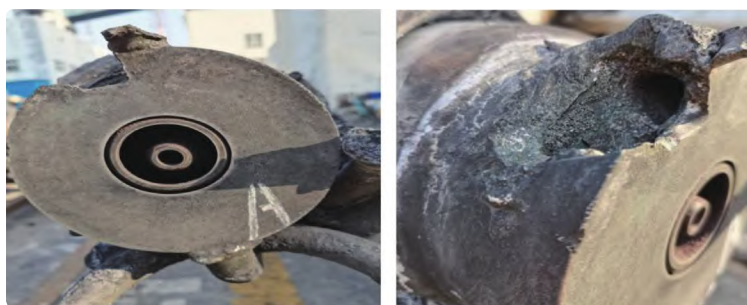
图3 烧嘴烧穿实况
