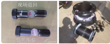
图 13 螺栓硬度检测及 PT 检测情况
