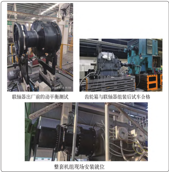
图 23 联轴器的调试、组装及现场安装情况
