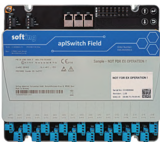
图3 首个作为原型可用的 Ethernet-APL 现场交换机
