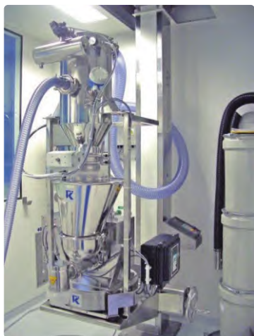
图5 科倍隆槽创失重式喂料机搭配真空上料机
