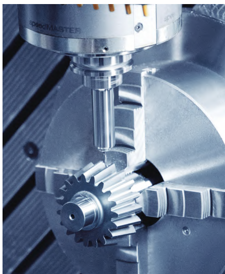
图 2 对于小型特殊齿轮，NAMCO 可选的机床包括配置 PH 150 自动化系统的 DMU 65 monoBLOCK 铣削加工中心
