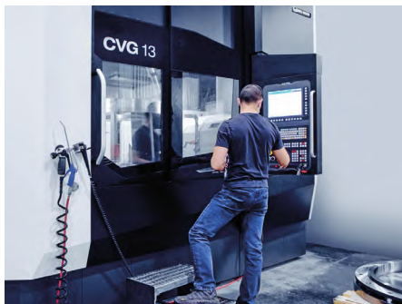
图 3 MCO 在精加工中选用的机床之一是 CVG13。可磨削大型工件，工件直径可达 1300 mm
