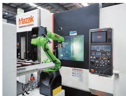
图 2 与自动化系统连接的复合加工中心 INTEGREX j-200S
