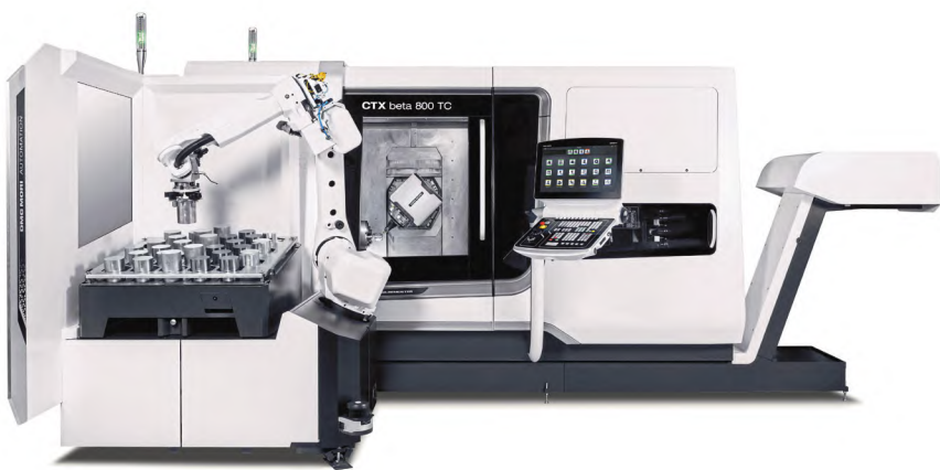
图2 Robo2Go 机器人与 CTX beta 800 TC 车铣加工中心相配合，大大提高了 Mönninghoff 公司三个班次的生产能力
