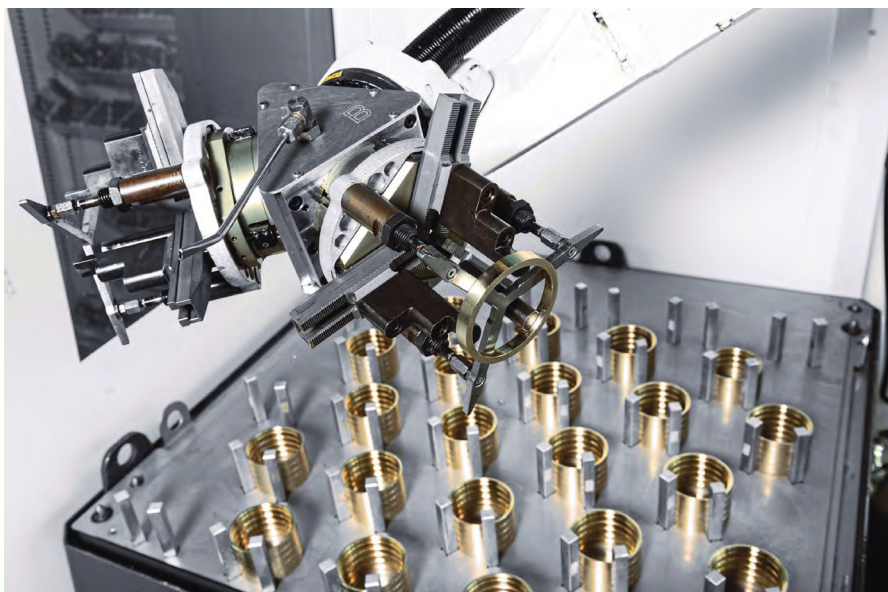
图 1 Robo2Go 机器人的料库有足够的空间存放毛坯，能够 24 h 不间断地为 CTX beta 800 TC 提供原材料
