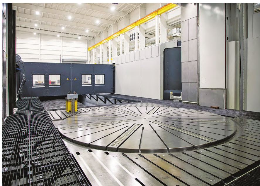
图 3 龙门加工中心的超大工作台
