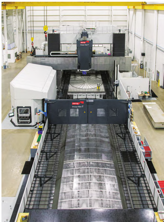
图 1 杜普莱恩 T 60 80 DT TT60 HR100 C 龙门加工中心
