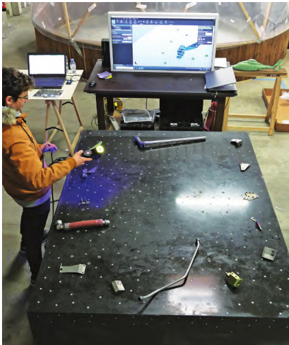
图 2 扫描完成后，工作人员会在 Creaform 形创的三维数据采集软件 VXelements 中处理文件这些托盘来运输。
