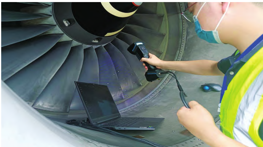
工作人员正在使用天远 FreeScan UE Pro 多功能激光手持三维扫描仪扫描发动机叶片上的小型破损区域
