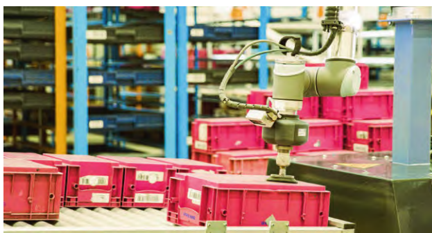
图4 得益于先进的安全保护系统，物流员工可以在没有笨重安全保护围栏的情况下与协作机器人一起工作
