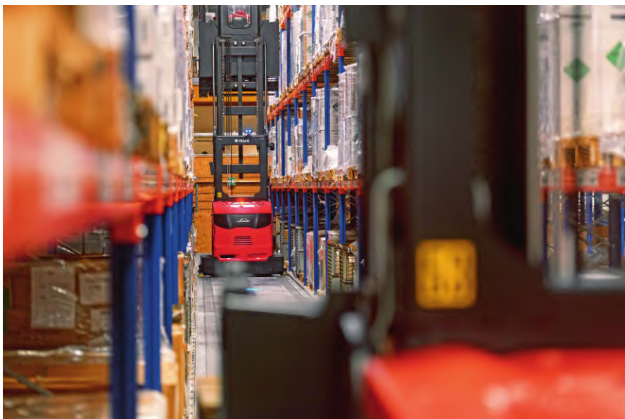
图 1 用户的订单由林德公司的 Warehouse Navigator 仓库管理系统直接发送到 Linde-K 型高架立体库拣选配货机器人处
