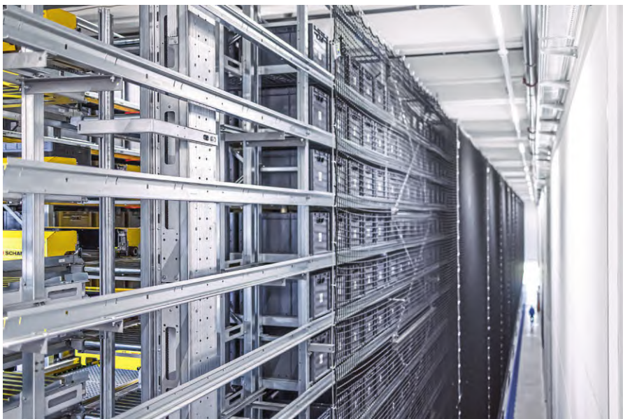
图 1 在 SSI-Cuby 穿梭车仓库 1500 m 2 面积上有 60 000 个双深周转箱的存放架口
