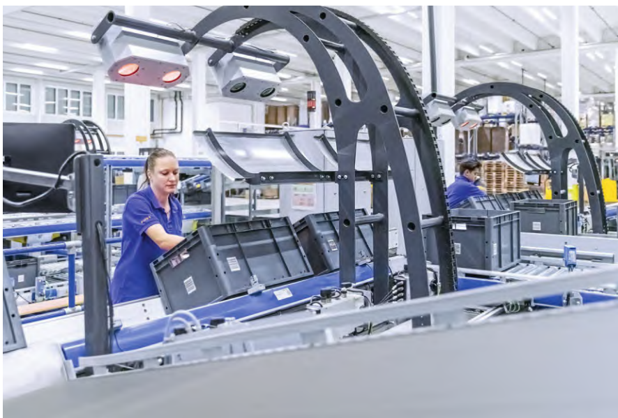
图3 由 6 个符合人体工程学原理的工作站来完成小件仓库用户订单的拣选配货
