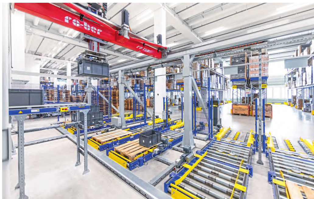
图2 销售门店订购的物资由龙门式机器人自动完成周转箱堆叠
