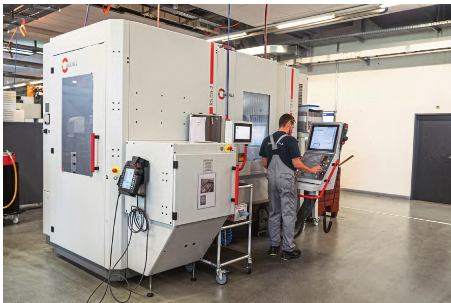
图 2 Hermle 公司的 C12 U 五轴铣削加工中心再加上 RS 05-2 机器人，在很小的空间里实现了最高的生产能力
