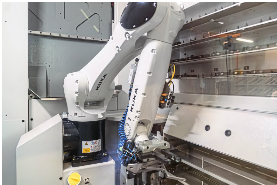
图 3 机器人夹具库（图片右上方）中存放着八对机械手
