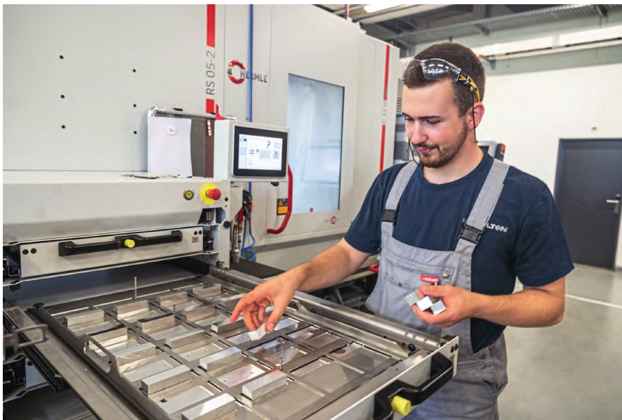
图 4 Fadri Pitsch 先生在向毛坯库中补充毛坯，确保 C 12 U 能够在无人值守的情况下有满足一整夜加工所需的毛坯
