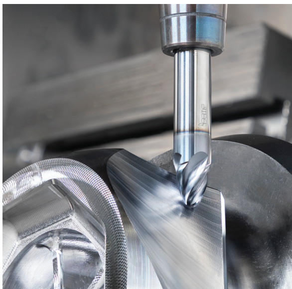
图 1 整体硬质合金桶形铣刀在曲线形状的加工中之有效
