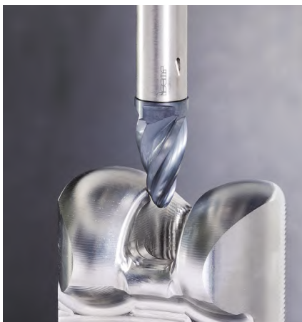
图 2 整硬可换头桶形刀头被成功应用于高成本效益的 MULTI-MASTER 设计理念中
