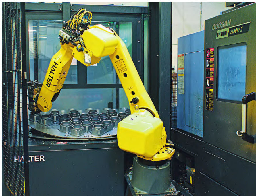
图 2 负载辅助万能支架适用于各种通用网格板，适用于矩形和旋转对称工件以及棒材
