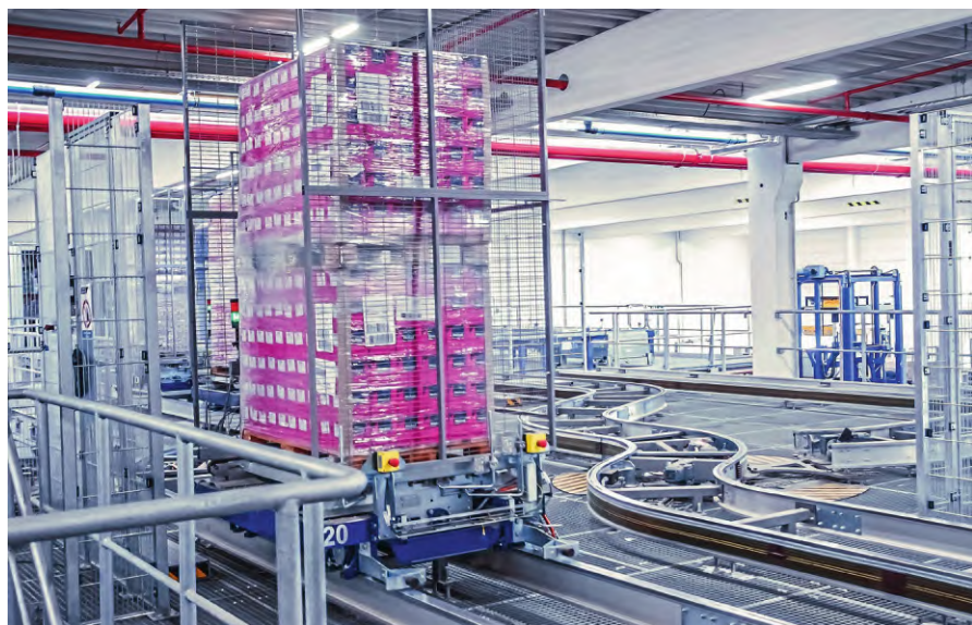
图 1 电动地面运输车轨道网络：作为 Vitakraft 物流中心项目的总承包商，MFI 公司负责项目各个阶段的所有工作
