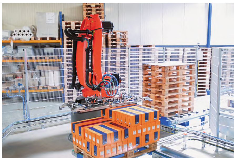
图3 利用机器人省去了托盘的人工手动堆垛工作
