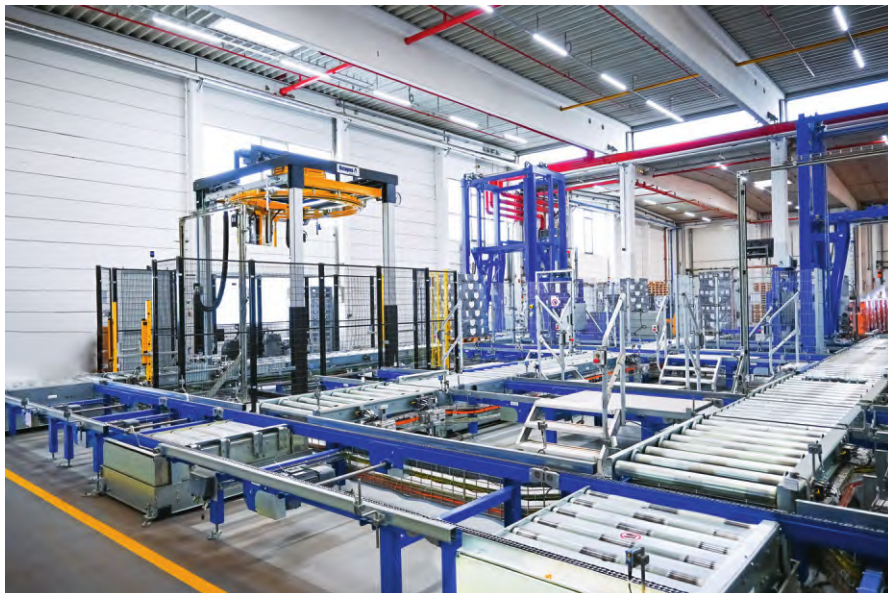
图2 物资入库处：输送带系统、双托盘堆垛机和打包机
