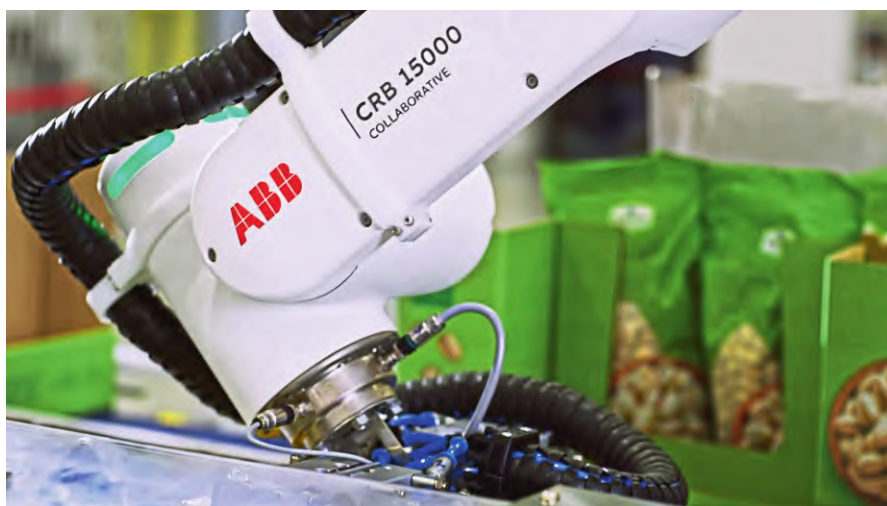
图 3 Dan D Pak 公司越南生产厂中使用的 ABB 机器人能够每天 24h 连续不断的完成腰果装袋任务
