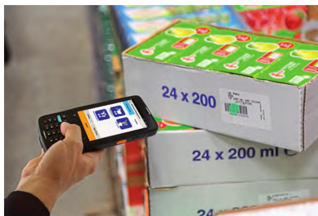
图 2 Menor K 强大的 2D 成像技术可以从任何表面读取 1D 条形码或者 2D 代码
