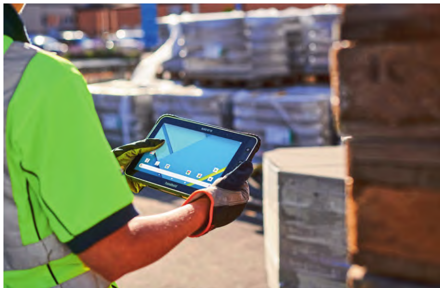
图 4 轻薄的便携式设备有着在阳光充足的环境中仍然清晰可见的高分辨率 10 inch 触摸显示屏，配有钢化玻璃以及防雨和手套等操作模式
