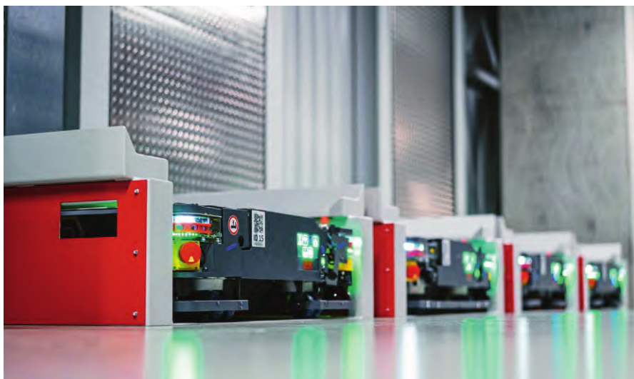
图1 SEW 公司开发的物料移动系统在物资入库处接收物资并自主导航，将其送达指定的地点
