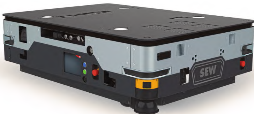
图 3 物料移动系统能够以每秒钟 1.6 m 的速度快速移动，可以运输 200 ~ 1500 kg 的物资
