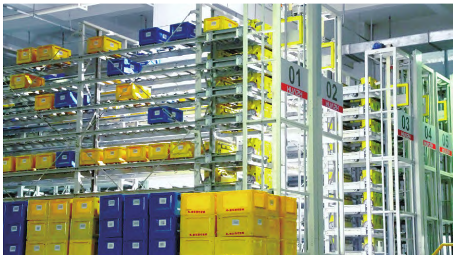
图3 华章智能为山西新华搭建多层穿梭机器人立库系统（11层，33台穿梭机器人）
