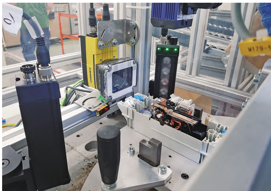
图 2 康耐视 In-Sight D900 视觉系统执行焊接检测
