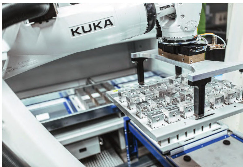
图6 五轴铣削加工中心可以生产加工 30 多种不同的铝合金和铸铁零件；每一批次的产品数量在 1~200 件之间
