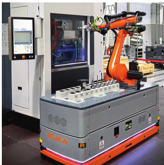
图5 KMR Cybertech 机器人将移动平台与机器人的优势整合到一起了。机械手准确地握住刀具，将其装入机床刀具库合适的刀位或者刀夹中
