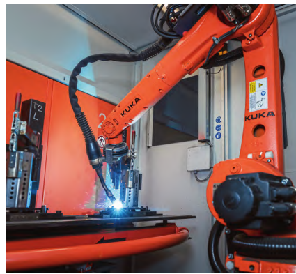
图4 细长的结构设计、很高的重复定位精度，KR Cybertech 焊接机器人能够焊接出非常完美的焊缝
