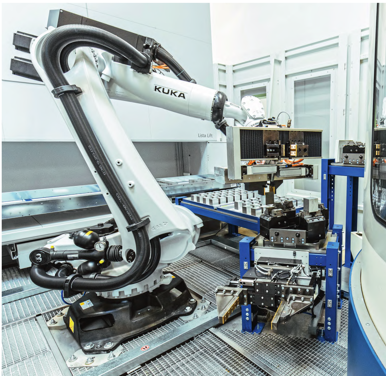
图1 Grob 集团公司生产制造的五轴加工中心确保能够非常精确地完成铝合金和铸铁零件的高精度切削加工，整个过程由加工单元的计算机控制
