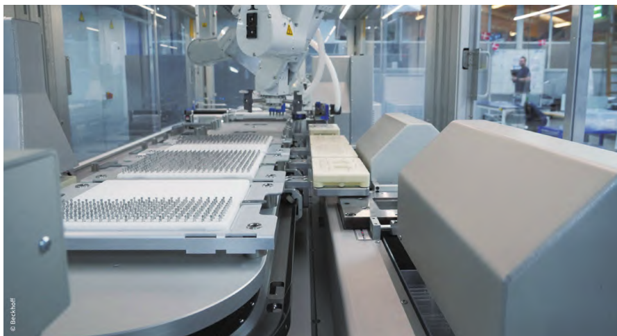
图 1 搬运机器人可以在与安装在设备底座正上方的 XTS 系统平行的机器单元顶部的导轨上自由地来回移动
