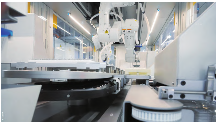
图3 基于 XTS 的泡罩包装设备采用模块化设计并可简单集成第三方组件，因此可以轻松通过添加模块的方式进行扩展，以完成装盒流程
