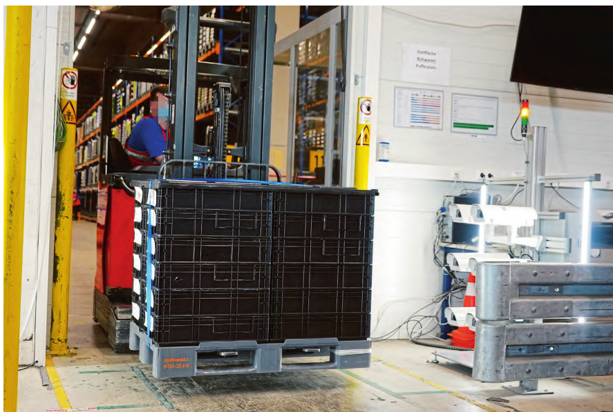
图 2 开门：扫描结束、一切正常之后，ZetesMedea ImageID 机器视觉门控系统就发出开门的指令将卷帘门打开
