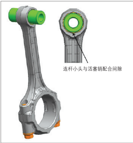
图2 连杆小头与活塞销配合间隙的测量值尚在标准范围内，但接近上差。
