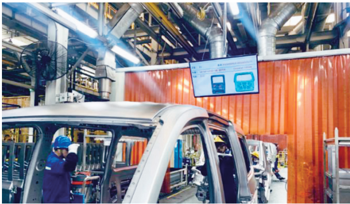
图 8 调整线车型配置扫码识别提示系统
