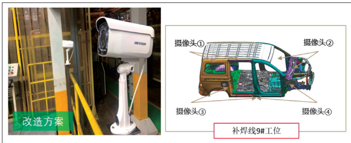
图 7 补焊线低成本智能焊点视觉系统
