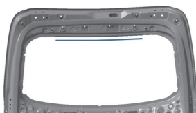
图12 点焊连接修改为包边
