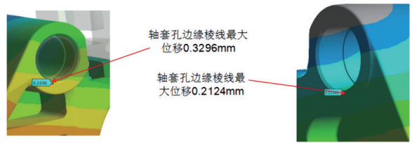
图6 拨叉轴孔受力变形
