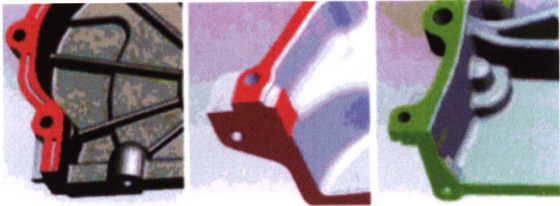
图5 几种常见正时罩盖储胶槽结构及面压测试
