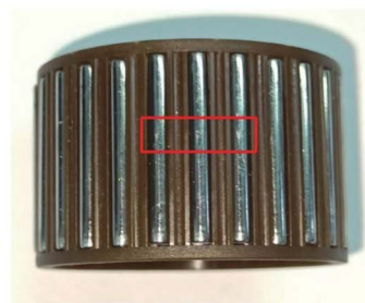
图8 模拟再现的挤压划痕
