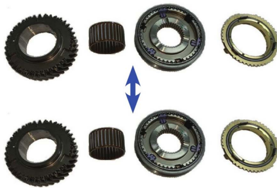
图3 二挡从动齿总成、二挡滚针轴承等ABA互换
