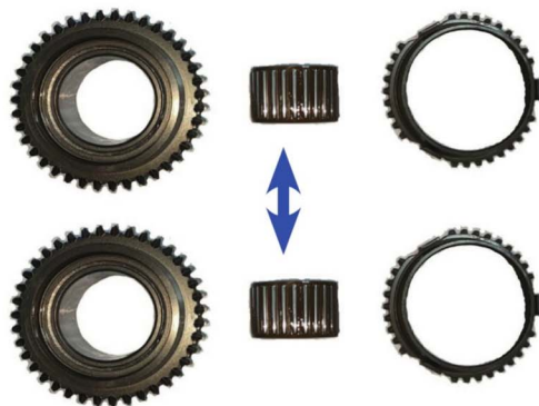
图4 三挡从动齿总成、三挡滚针轴承等ABA互换
