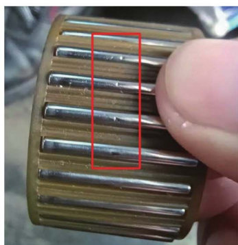
图6 部分滚针中段有三角形凹痕
