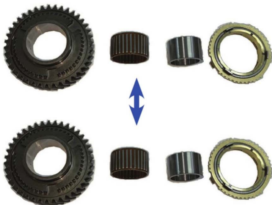
图2 一挡从动齿总成、一挡滚针轴承等ABA互换
