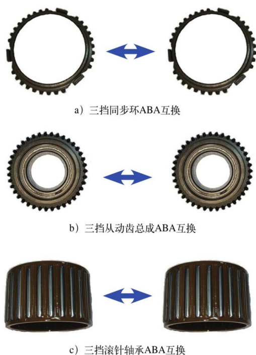
图5 三挡同步环、三挡从动齿、三挡滚针轴承依次进行ABA互换
