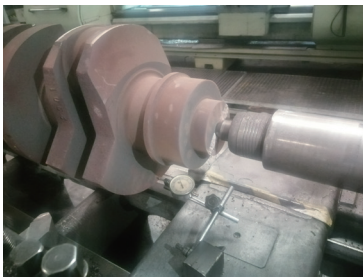
图5 曲轴压缩量测量
