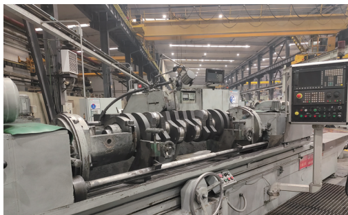
图4 连杆颈磨削加工
