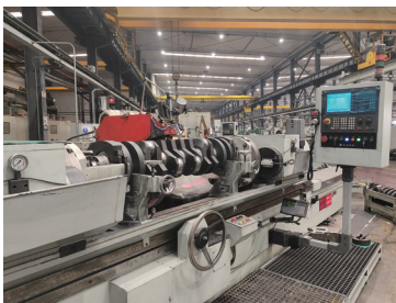
图6 头尾架数控伺服同步系统驱动
