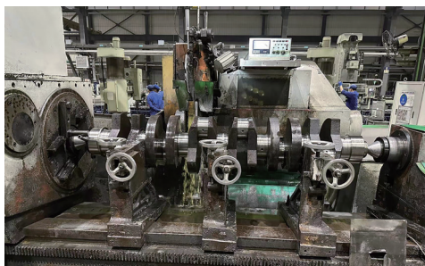
图3 主轴颈磨削加工
