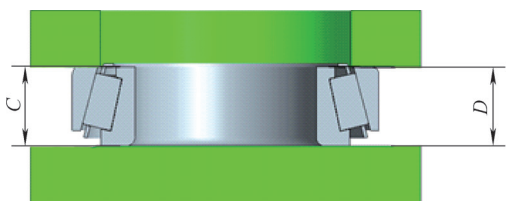
图17 尺寸C、D测量示意
